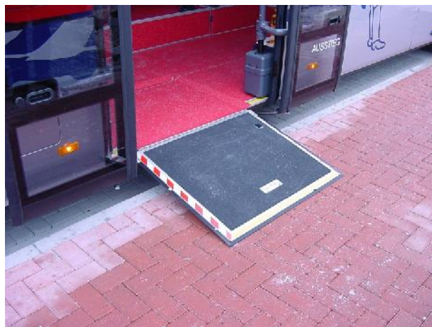
Abbildung: A - 11, Rampe zur Verbesserung eines barrierefreien Ein- und Ausstiegs
